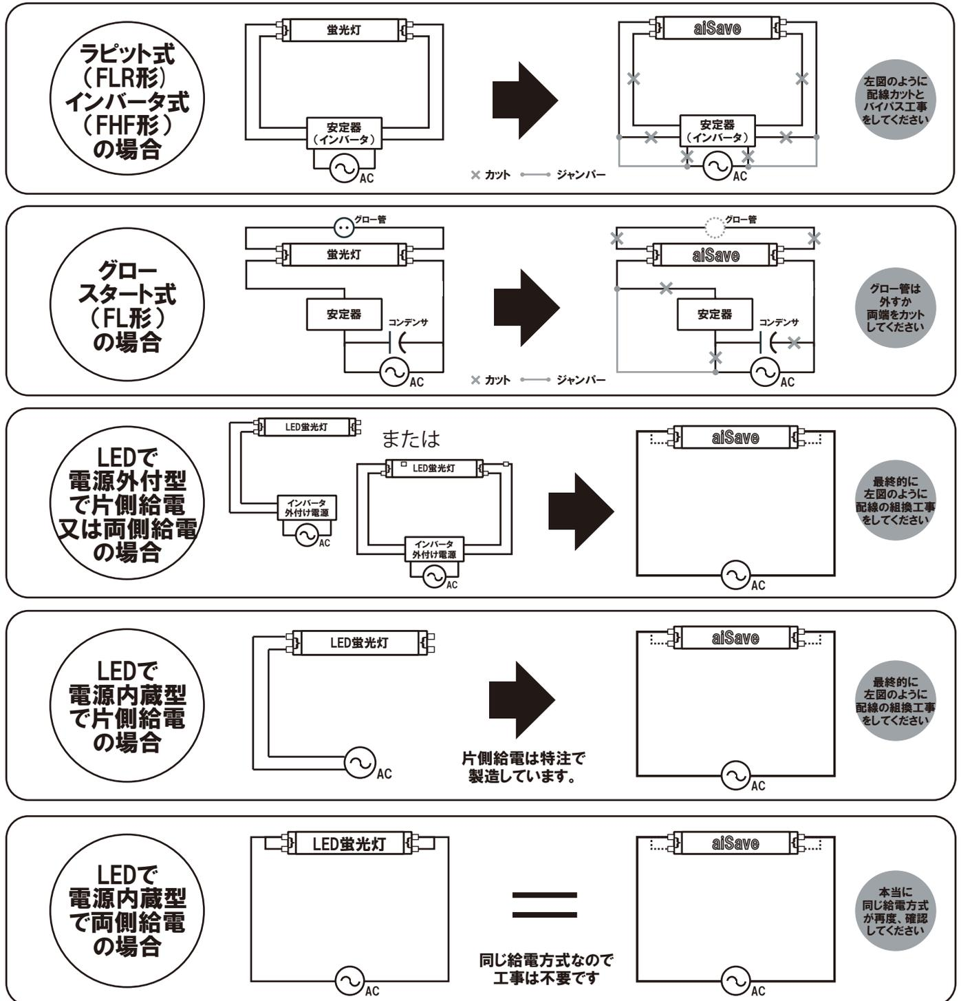
誤った取り付けは、短絡や火災等の思わぬ事故や製品の故障の原因となりますので必ず既設照明の配線方式を確認してから、本製品を取り付けてください。
