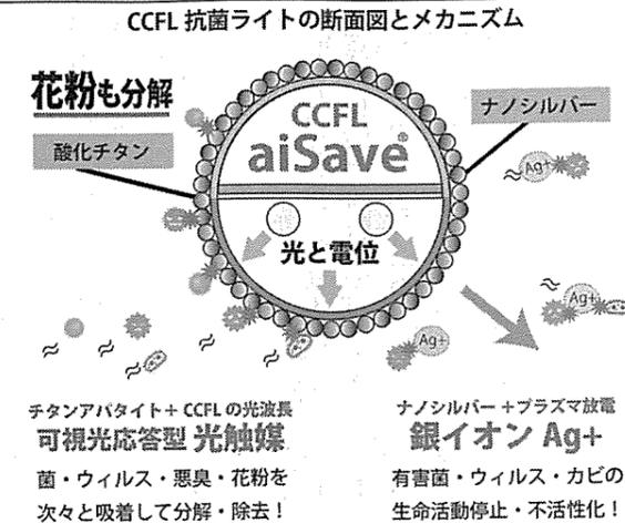
素の動きを停止させる不活性化によって窒息・死滅できる(図参照)。さらに酸化チタンに光が照射されると生じる光触媒反応でライト付近に接する浮遊菌や有機物(汚れ・花粉など)に対し、次々と瞬時に働き、水や二酸化炭素に分解する。当然、人体には無害である。
